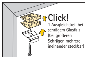
Halter unter Ausgleichskeil setzen und zusammen unter die schräge Glasleiste schrauben
